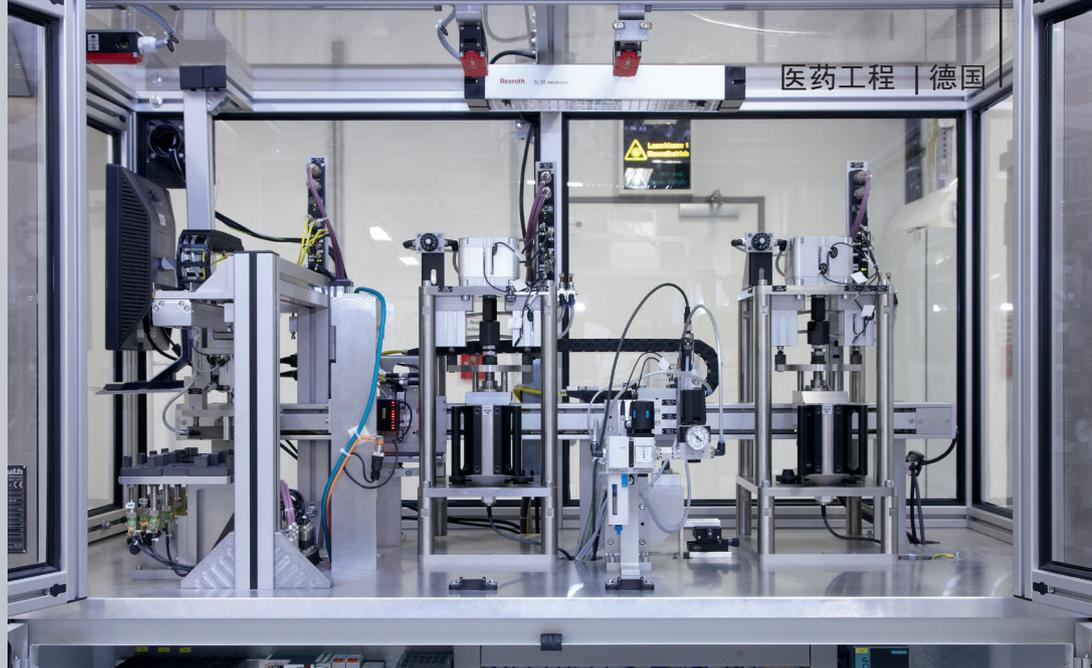
eFlow® 吸入装置的烟雾发生器的复杂生产工作会在不下 12 个生产和测试设施中进行。为了在不同的机械加工操作中实现无缝追踪，每个生产步骤前，部件都必须被扫描和确认。这通过基于 Oracle 数据库和 Beckhoff 控制平台的系统得以实现。
